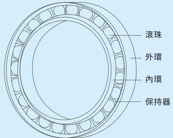
圖1-1：薄型軸承結構圖
